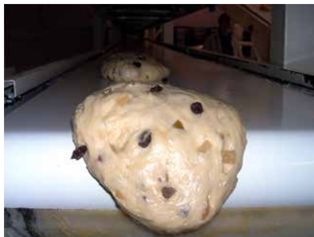
Décollement de pâtes crues adhérentes
