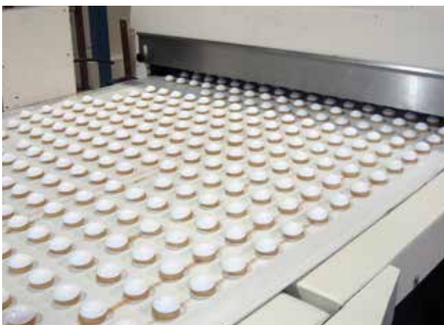
Alimentation du tunnel de refroidissement
